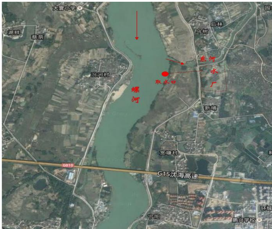
图 5.3-2 螺河保护区内各自来水厂与取水口的位置关系示意图
